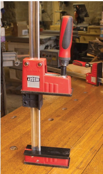
L'applicazione in cui i K Body danno il meglio di sé. La chiusura di casse e telai in squadra. Questa loro particolarità consente un notevole risparmio di tempo e strettoi.
