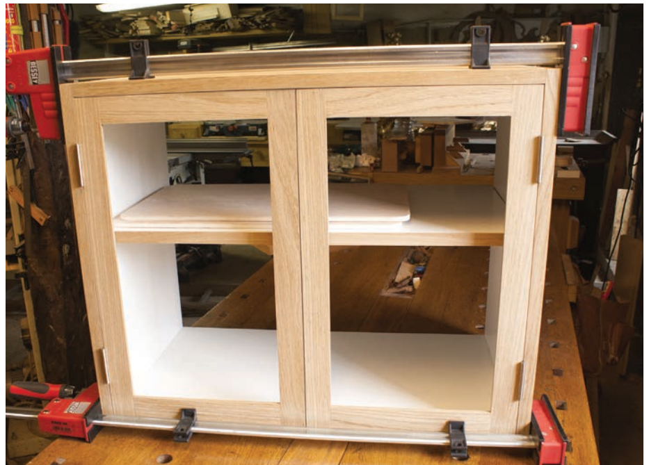
L'applicazione in cui i K Body danno il meglio di sé. La chiusura di casse e telai in squadra. Questa loro particolarità consente un notevole risparmio di tempo e strettoi.
