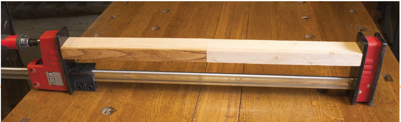
Una prova empirica per testare la complanarità delle ganasce. Due listelli di base 25x50 mm sono stati serrati testa contro testa. Anche applicando una notevole forza non si sono rilevati spostamenti anomali.
