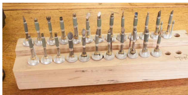
La varietà di punte abbinabili all'R200 è notevole. Si va da quelle a stelo con punta tonda, adatte alla scontornatura, fino a quelle a paletta, dedicate alla sfumatura. Alla base recano una filettatura che le fissa saldamente al manipolo.
